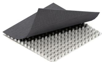
Los productos de drenaje de hoja de geocompuesto de la serie 180 de SITEDRAIN están compuestos por un núcleo polimérico con hoyuelos con un geotextil adherido al lado del hoyuelo. El geotextil permite que el agua pase mientras retiene los materiales de relleno. El núcleo sólido permite la recolección de agua de un lado y proporciona una ruta de flujo continuo a las salidas de drenaje designadas.
